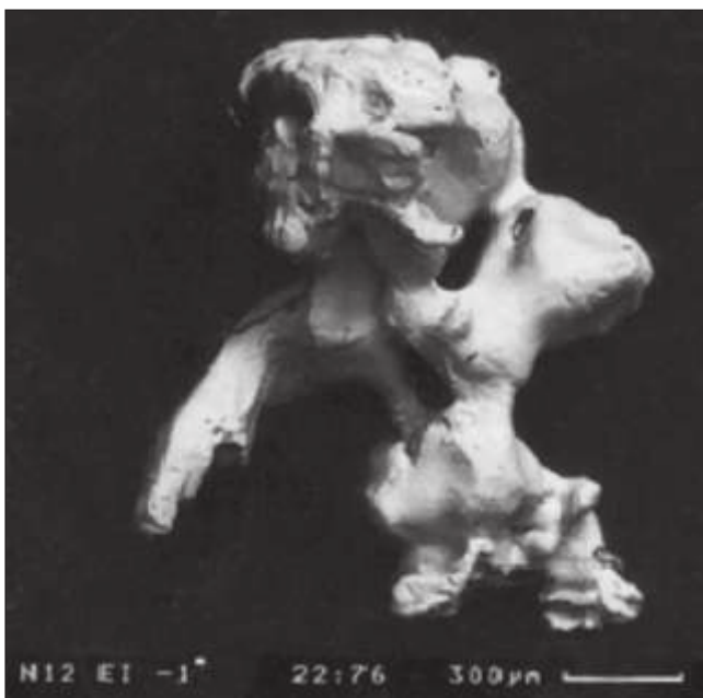
Золотой самородок, выделенный из породы электроимпульсным способом разрушения
